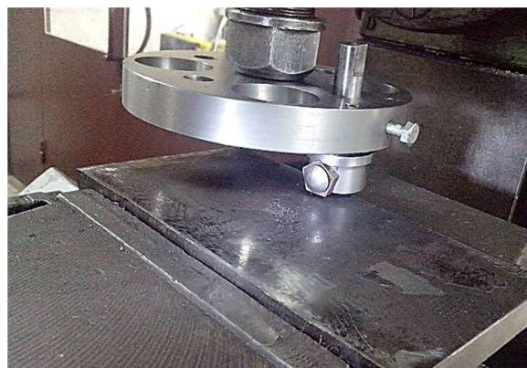
Рис. 2. Фотография устройства для удаления окалины, установленного на вертикально-фрезерном станке
